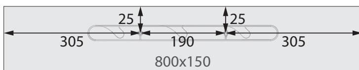
Afbeelding 5 Boorafstanden voor het formaat 80x15x15 cm – alle afstanden in mm
