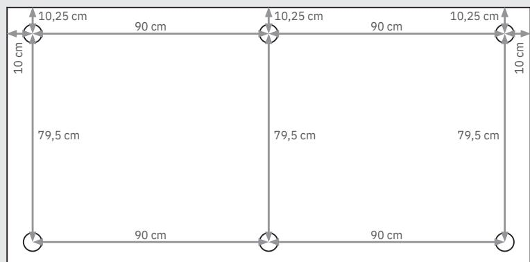
Angaben von Bohrlochmitte zu Bohrlochmitte | Measurements from centre of one drill hole to the other | Distances entre les centres des trous de perçage
