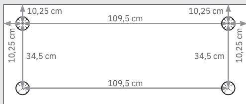
Angaben von Bohrlochmitte zu Bohrlochmitte | Measurements from centre of one drill hole to the other | Distances entre les centres des trous de perçage
