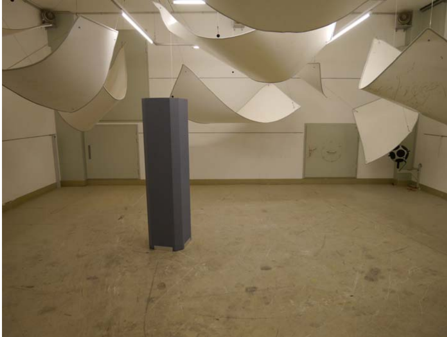
Abbildung B.1. Anordnung der Säule im Hallraum (eine von insgesamt fünf Positionen).
