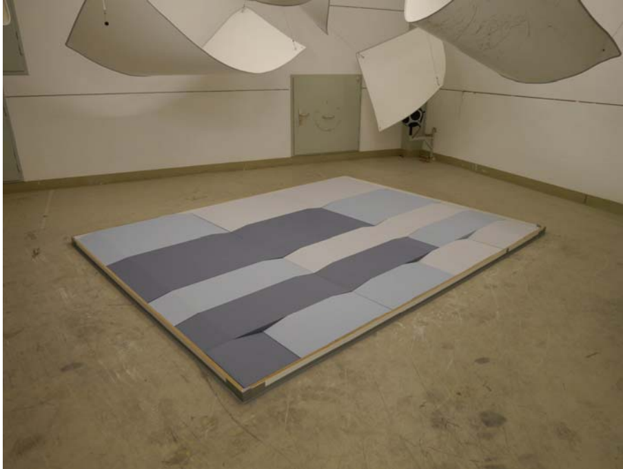
Abbildung B.1. Anordnung der Wandpaneele im Hallraum.
