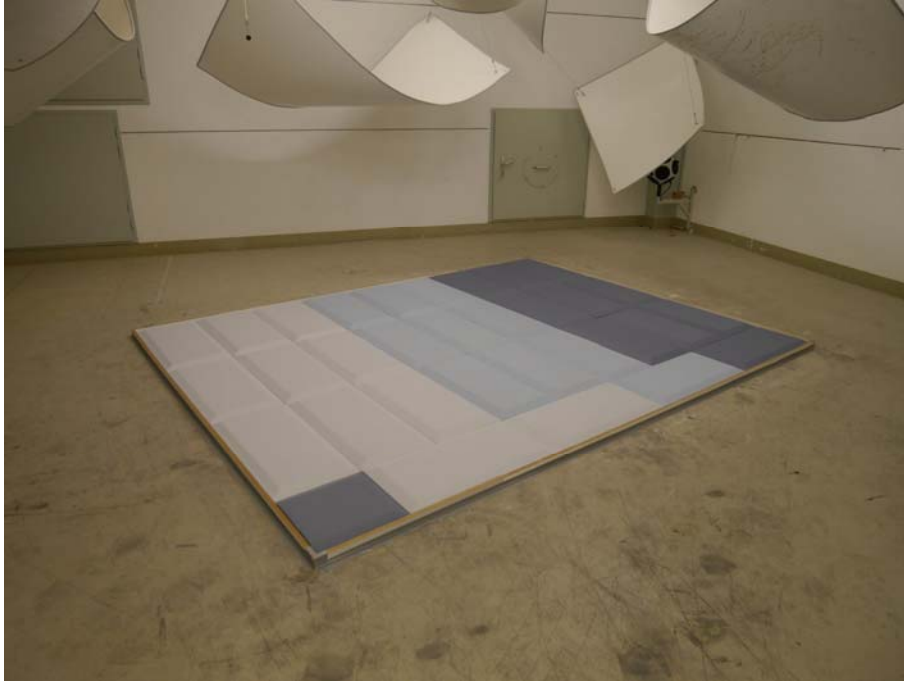
Abbildung B.1. Anordnung der Wandpaneele im Hallraum.
